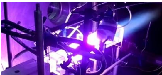
Рис. 6. Фотография плазменно-стимулированного горения пропан-воздушного топлива в расширяющемся аэродинамическом канале длиной L=50 см.
