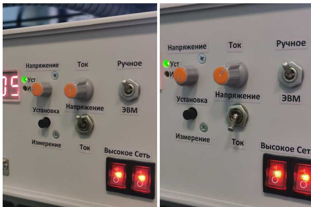
Рис.9. Источник питания, регулировка напряжения (а), регулировка тока (б).
