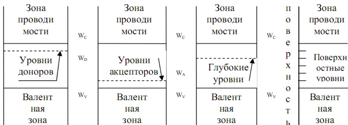
Рисунок 8. Зонные диаграммы примесных полупроводников.
