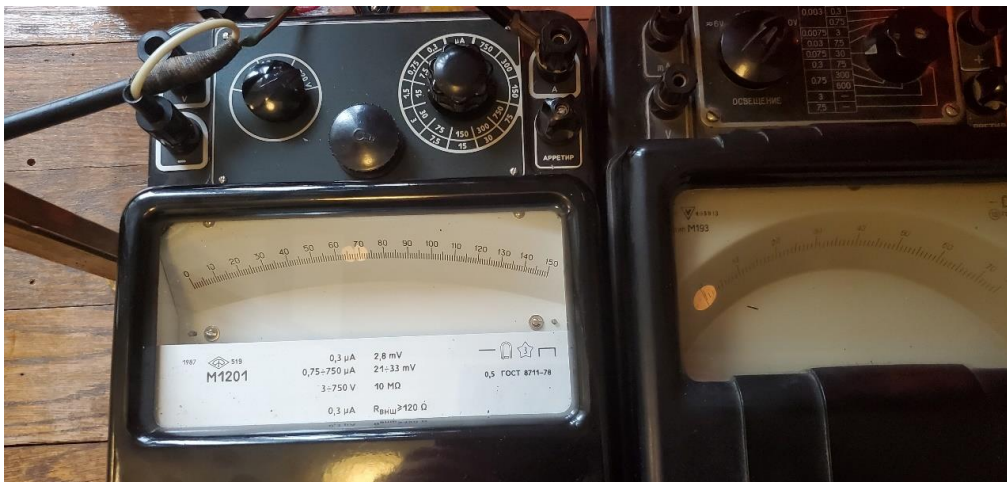
Рис. 10. Приборы для измерения сигнала с измерительной линии ИЛ-1 (слева) и детекторной секции (справа).
