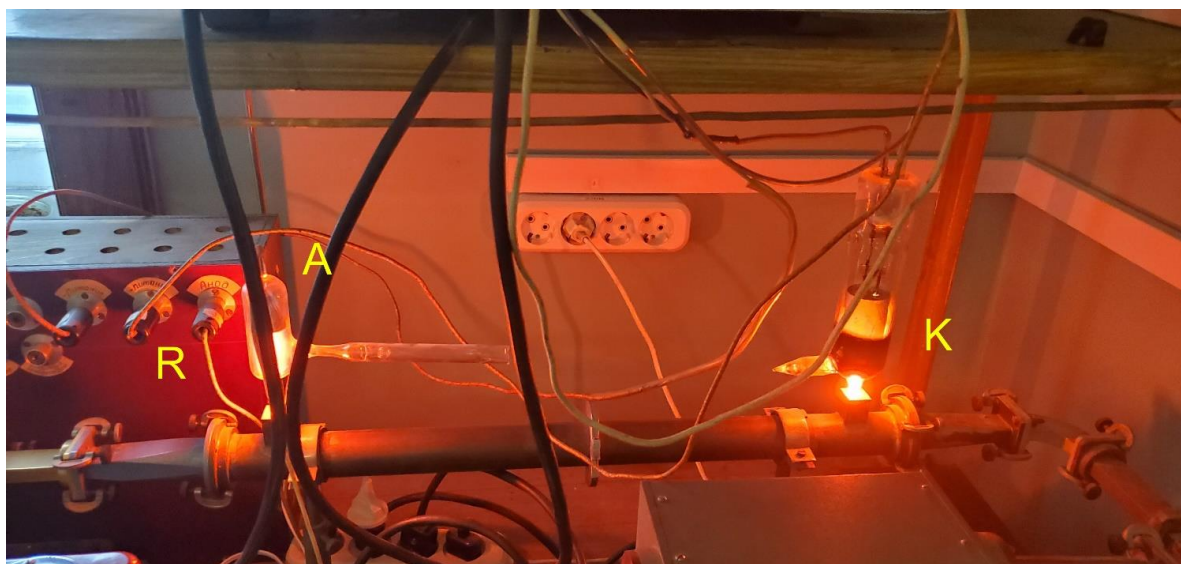
Рис. 12. Разрядная трубка (К – катод, А – Анод). R – Выводы балластного резистора.
