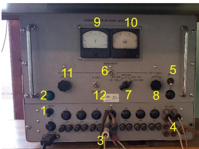
Рис 11. Источник питания УИП-1 (слева) и прибор для измерения тока разряда (справа).
