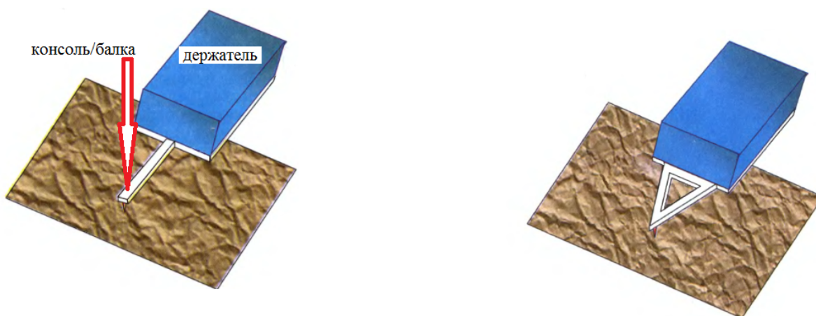
Рисунок 4. Виды балок (консолей) кантилеверов: (а) – мягкого типа, (б) – жёсткого типа.
