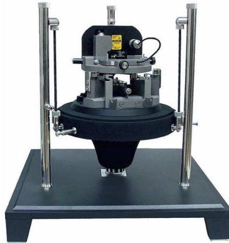
Рисунок 2. Классическая модель АСМ на примере СЗМ от компании NT-MDT.
