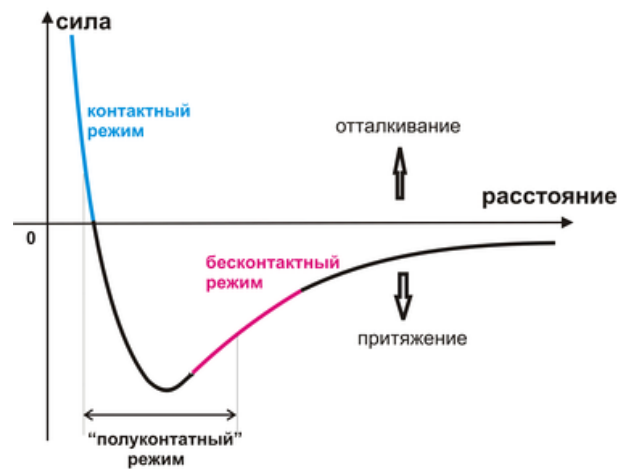
Рисунок 8. Зависимость силы Ван-дер-Ваальса от расстояния между кантилевером и поверхностью образца.
