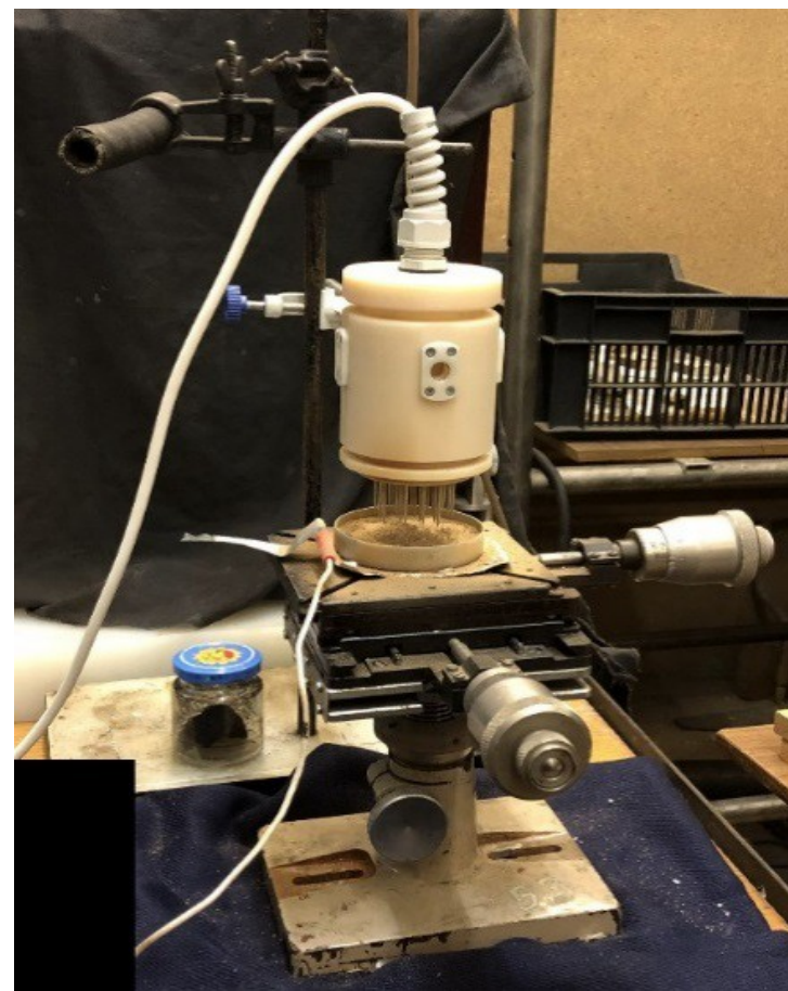
Фотография многоигольчатого капиллярного плазмотрона.
