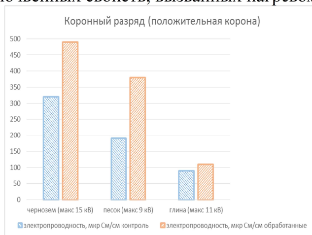
Рис. 15: Изменение электропроводности образцов при положительной полярности коронного разряда
