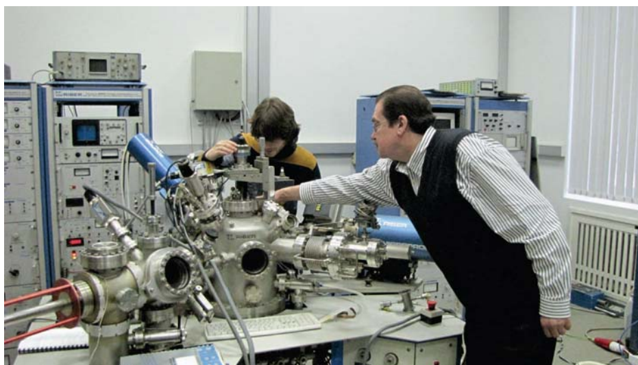
Аналитическая и технологическая сверхвысоковакуумная установка «Surface Center» (Riber, France) для широкого спектра исследований поверхности
