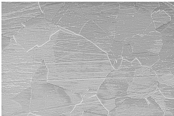
Рис. 1.46. Поверхность поликристаллического сплава NiPd после травления ионами аргона с энергией 3 кэВ. Увеличение – 1500.
