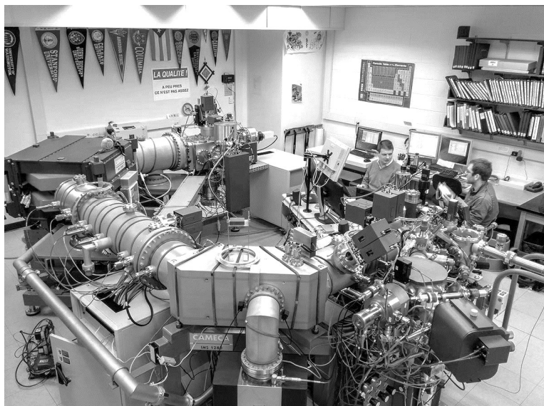
Рис. 6.4. a – траектории частиц в магнитном поле (поворот на 180^\circ ); б – внешний вид установки МСВИ с магнитным масс-анализатором.
